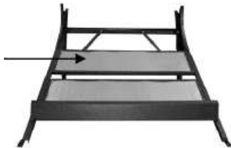
Figura 2 colocación de los reflectores
