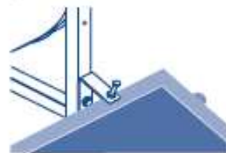
Figura 3 Sujeción de colector solar
