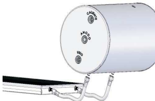
Figura 3 Conexión colector solar con termotanque
