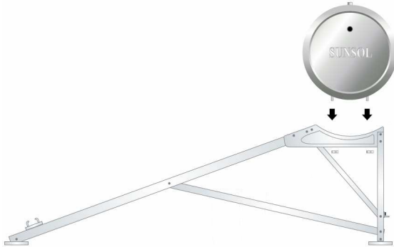
Figura 3 Colocación del termotanque
