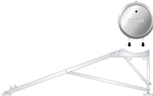
3 Colocación del termotanque
