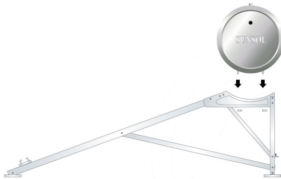
Figura 3 Colocación del termotanque
