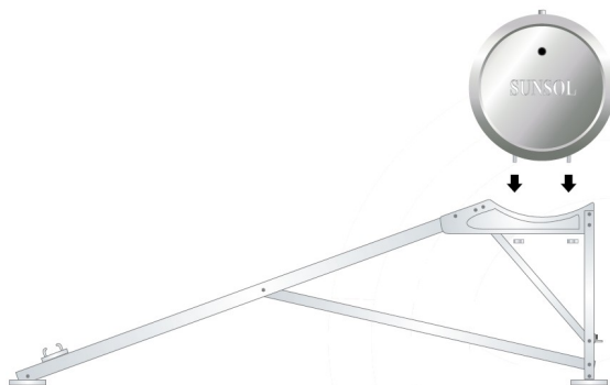
Figura 3 Colocación del termotanque
