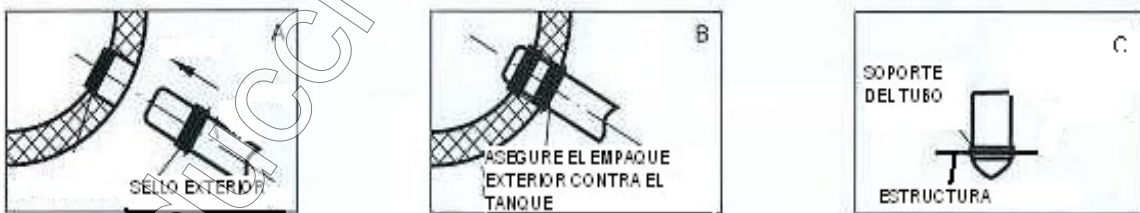
Figura 2 Instalación de tubos de vacío
