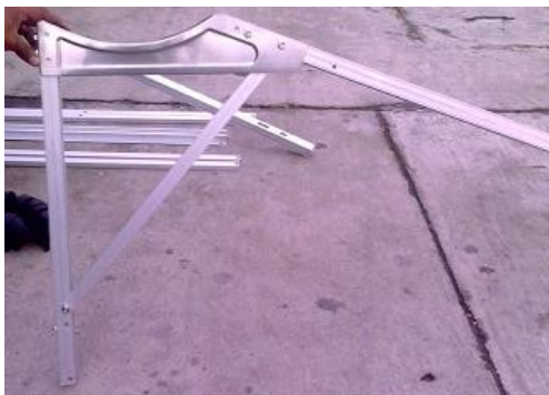
Figura 4 Armado de refuerzos laterales
