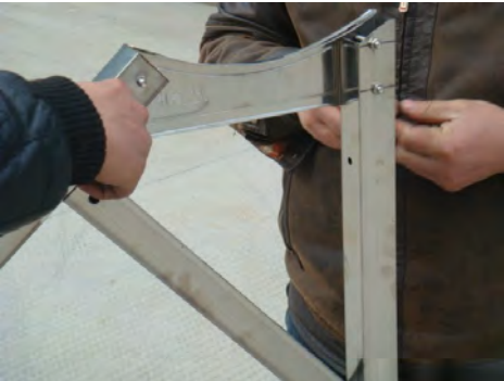
Figura 2 Lateral con soporte de tanque.
