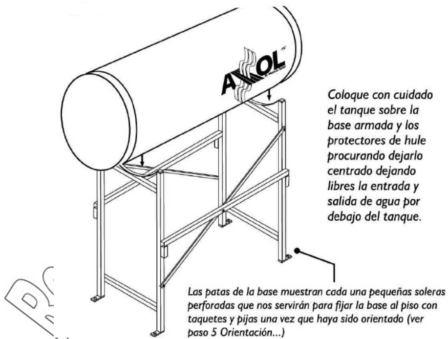
Figura 3 colocación del termotanque
